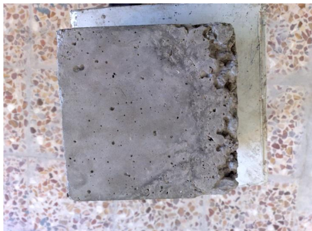
شکل ۳: نمونه غوطه ور ۷۰ روزه در محلول سولفات منیزیم
