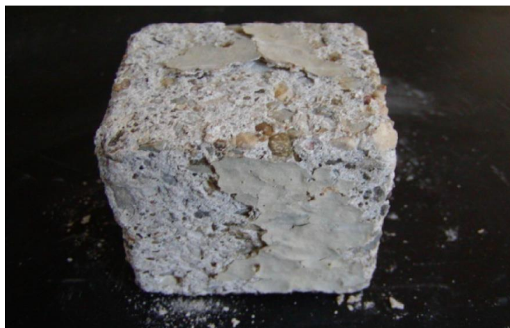
شکل ۴: نمونه با طرح اختلاط پس از ۱۴۰ روز قرار گرفتن در معرض سولفات منیزیم
