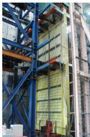
شکل (۲) - جزییات سازه های دیوار برشی فولادی در آزمایشگاه، برونو (۲۰۰۸) [۱۹]
