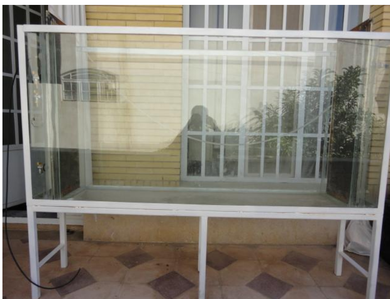
شکل ۲-۳- جعبه ی آزمایش با ابعاد اصلی ۱۷۰ \times ۸۲/۵
