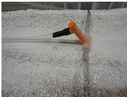
شکل ۳-۴- لوله ی انتهایی جهت ورود آلاینده به محیط خاک
