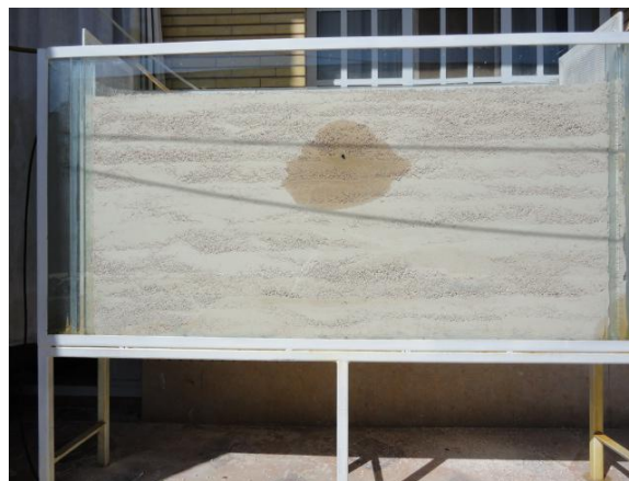
شکل ۳-۸- تصویری از نحوه ی انتشار آلاینده در ماسه در حین انجام آزمایش
