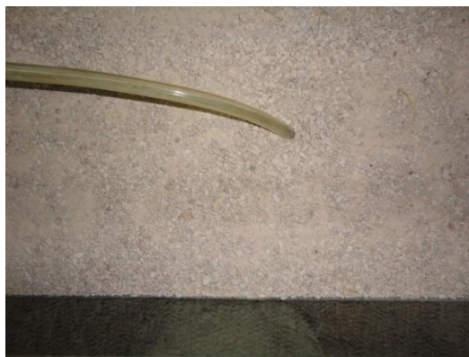
شکل ۳-۵- تصویر از بالای محل ورود لوله ی عبور آلاینده مدل تکمیلی و آماده جهت شروع آزمایش
