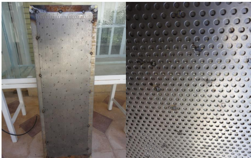
شکل ۳-۳- صفحه ی فلزی جدا کننده ی محیط خاکی با منافذ ریز جهت عبور سیال آلاینده
