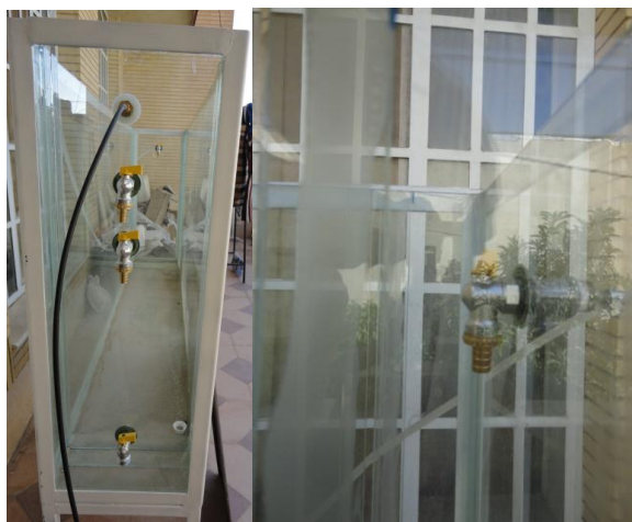
شکل ۳-۴- شیرهای تعبیه شده در طرفین جعبه ی شیشه ای جهت ورود و خروج سیالات
