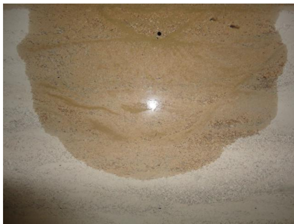
شکل ۳-۹- تصویری از نحوه ی انتشار آلاینده در ماسه در حین انجام آزمایش و در ساعات پایانی
