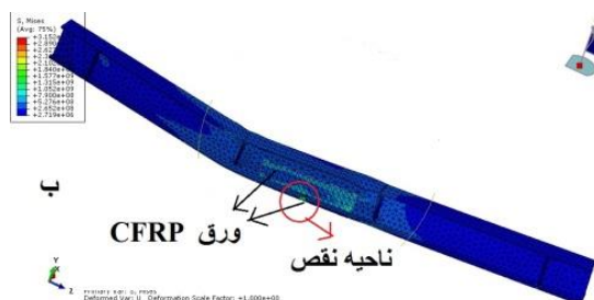
شکل ۱۴: تیر با نقص یک طرفه با دوطول ۴۰۰+۴۰۰ میلی متر CFRP
